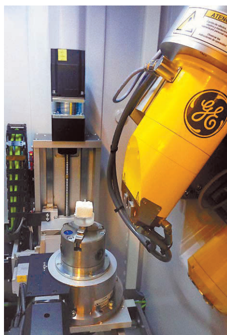
Cámara interna del microCT preparada para escanear una pieza dental. Foto: GAD CENIEH
